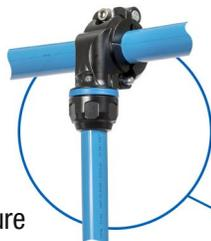
L'accumulation d'eau dans la section inférieure du tube ne s'infiltrera pas dans la descente, elle se dirigera vers un point plus bas de la ligne dans une descente munie d'un purgeur pour éliminer les condensats
