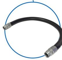
Un tuyau flexible antivibration haute température installé entre le compresseur et le début du réseau de distribution permet de réduire la vibration et la chaleur produites par le compresseur.
