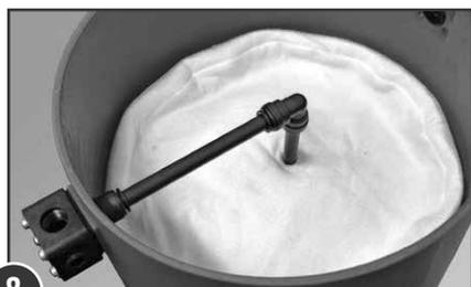
**8** Connecter le tube de filtre au bloc d'entrée en utilisant les raccords fournis
