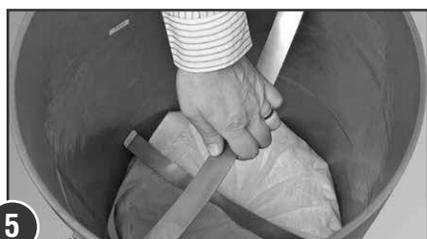
**5** Insérez le(s) ressort(s) de retenue métallique(s) avec les extrémités courbées. Glisser vers le bas jusqu'à ce qu'il touche le haut du sac filtrant. NE PAS comprimer le sac filtrant
