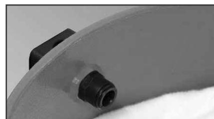
**7** Visser le connecteur d'entrée (raccord de réduction) en place fermement
